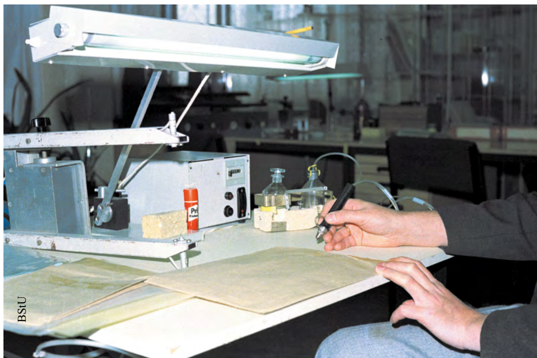
Miejsce pracy i urządzenia do prześwietlania, otwierania, powielania i zamykania przesylek pocztowych, ok. 1986 r. (BStU, MfS, Abt. M/Fo/29)
